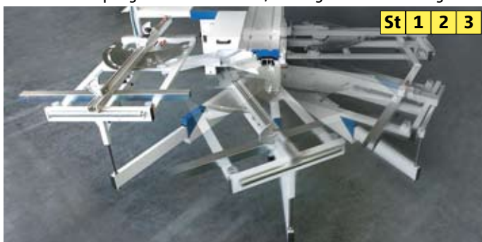
Wegschwenkvorrichtung für Querschlitten schnelles und ergonomisches Schieben in die Parkposition
