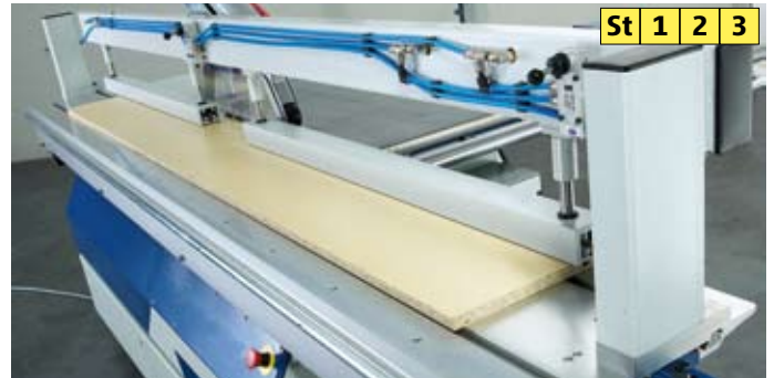
Druckbalken für Furnierpakete, dünne Platten etc.
