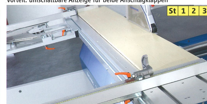
Parellelanschlag links vom Sägeblatt zum Schneiden von langen und schmalen Teilen
