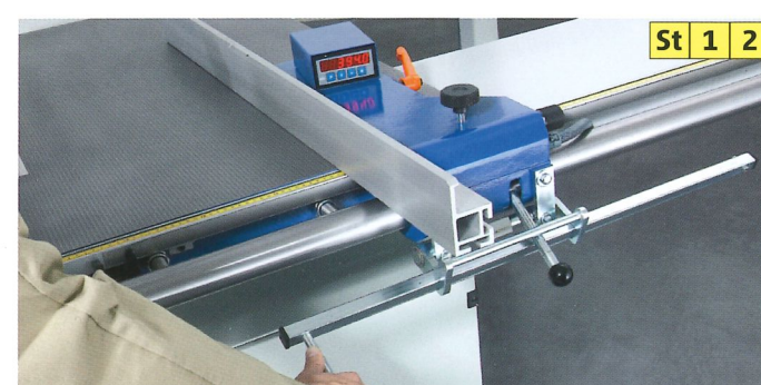
R-4 Fernbedienung mit Digit PA zur einfachen Einstellung des Breitenmaßes von der Bedienerseite
