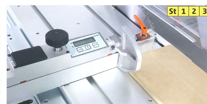
Tele-Digit digitale, kabellose Maßanzeige für Längenanschlag Vorteil: umschaltbare Anzeige für beide Anschlagklappen
