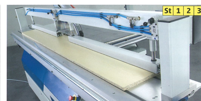
Druckbalken für Furnierpakete, dünne Platten etc.
