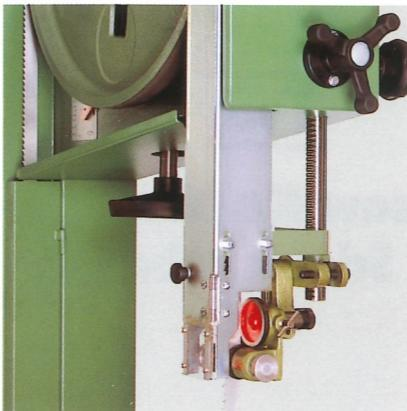
Mechanische Höhenverstellung der oberen Führung durch Handrad und Sperritzel.
