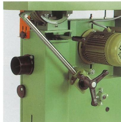
Tischschwenkvorrichtung mit Handrad.
