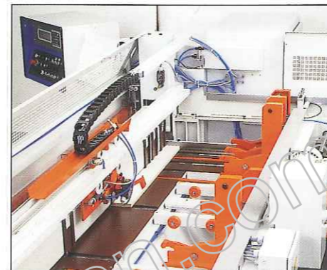
▲ Der Druckbalken hält das Material unverrückbar
