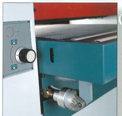
Centraggio automatico a cinghia Automatic belt centering Automatische Förderbandzentrierung Centrage automatique tapis Posicionador automático de la mesa
