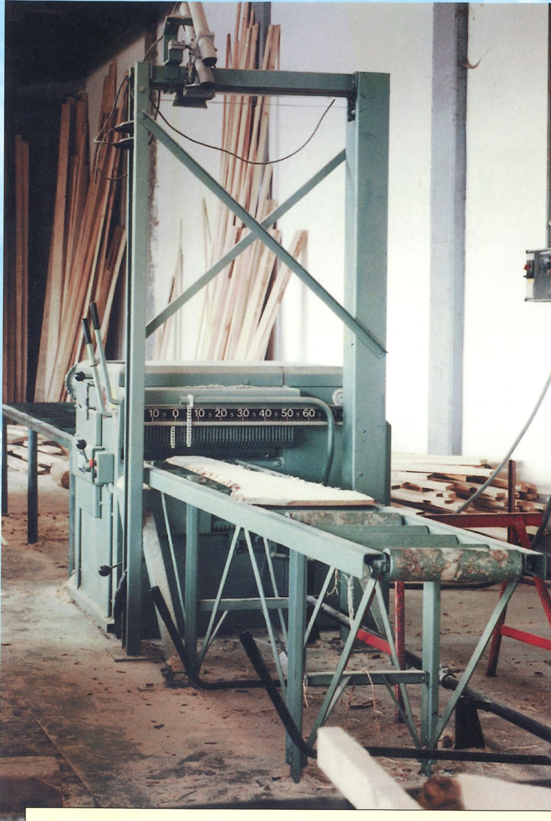
Abb. 2: Modell KME 2/750 in teilhydraulischer Ausführung mit Laserrichtlicht (Sonderausstattung)
