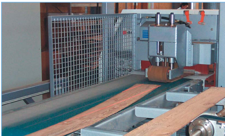
Abb. 41 Anlage zum Auftrennen von Deckschichtlamellen für Fertigparkett, bestehend aus Mehrblattsäge K34GI/800 in Sonderausführung mit verstellbarem Sägeblatt und ...
