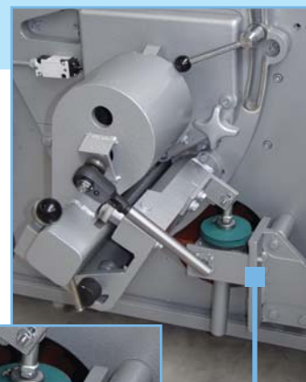
Abb. 12 Höheneinstellung der Sägewelle durch Elektrohubspeindeltrieb
