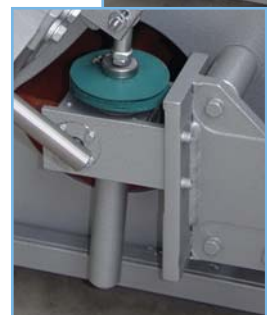
Abb. 12 Höheneinstellung der Sägewelle durch Elektrohubspeindeltrieb
