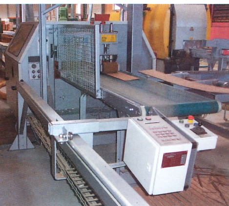
Abb. 34 K34 G mit Laserportal und Mechanisierung (zur Herstellung der Deckschichten von Fertigparkett)
