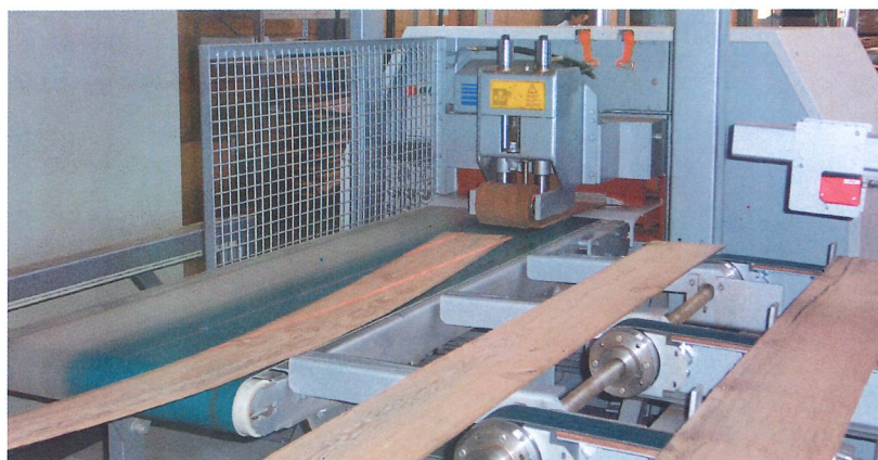
Abb. 34 K34 G mit Laserportal und Mechanisierung (zur Herstellung der Deckschichten von Fertigparkett)
