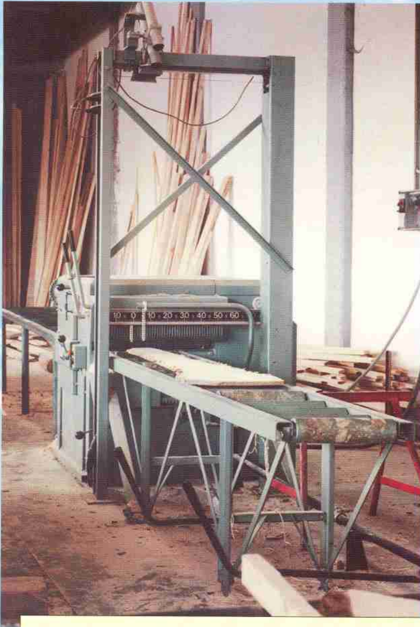
Abb. 2: Modell KME 2I750 in teilhydraulischer Ausführung mit Laserrichtlicht (Sonderausstattung)
