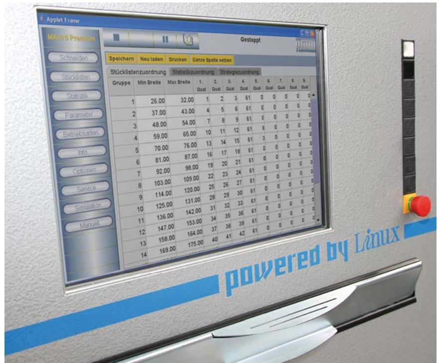
Abb. 1 Bedienterminal der MAXI 6 Steuerung mit Touchscreen
