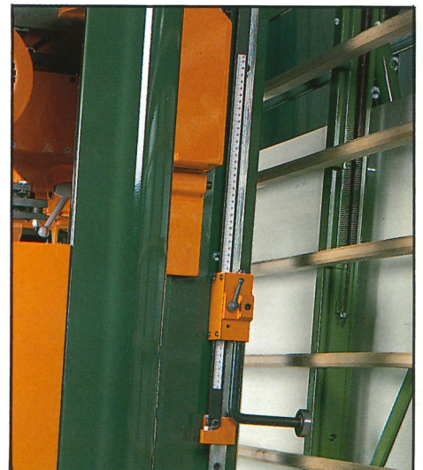
Taglio striscie orizzontali. Repeat cutting of horizontal strips. Waagrechter Streifenanschlag. Corte tiras horizontales.
