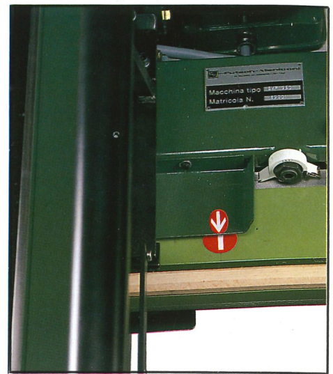
Carrello superiore con indicazione punto bloccaggio. Upper carriage with locking point indication. Oberer Laufwagen mit Blockierposition. Carro superior, con indicación de la posición de bloqueo.
