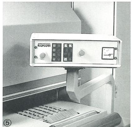
Die vorgezogene Transportkette ermöglicht den selbständigen Einzug der Werkstücke. Die Transportkette hat eine Breite von 330 mm und ist aus Spezialguß hergestellt. Die rechts neben der Vorschubkette angeordnete Antriebskette fördert zusätzlich kontinuierlich Spreißel und Abfälle aus der Maschine. Die Produktionssicherheit wird wesentlich erhöht.
