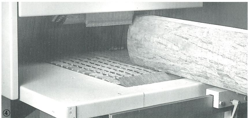
Mit Hilfe des neu entwickelten Verschiebekopfes können minimale Leistenbreiten zwischen den beweglichen Sägeblättern geschnitten werden. Neben den beweglichen Sägen können zusätzlich feste Sägeblätter eingesetzt werden. Diese Kombination ermöglicht einen sehr flexiblen und optimierten Modelleinschnitt.
