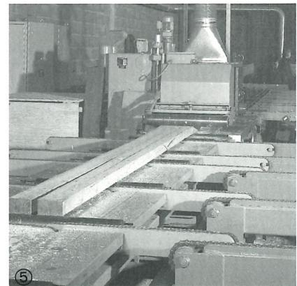
Der integrierte Schallschutz reduziert den raumkorrigierten Lärmpegel und verbessert somit das Arbeitsumfeld für das Bedienpersonal (Abb. 1).
