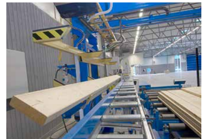
Holz kurz vor dem Wenden und Ablegen auf der Zufuhrbahn
