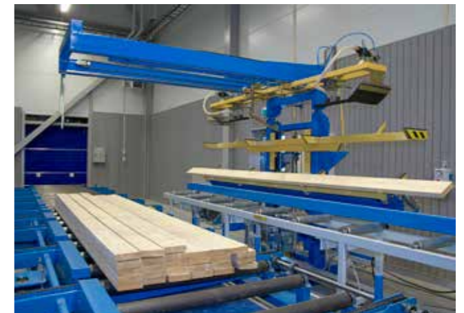
Holzbeschickung mit zusätzlicher Rollenbahn
