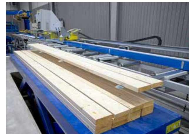
Das bearbeitete Holz wird auf einem Hubtisch gestapelt
