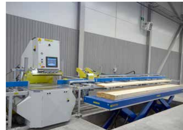
SPL728 mit Ausförderbahn und Hubtisch
