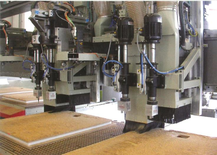
Sechs Vertikalfräsaggregate und vier Vertikalbohr-einheiten sind auf der Portalvorderseite auf zwei über NC-Achse zueinander verstellbaren, getrennten Aggregatträgern angeordnet. Vor den zwei Frässpindeln mit automatischer Werkzeugwechsel-einrichtung ist je ein automatisches Tellermagazin für 10 Werkzeuge angebracht und ermöglicht einen Werkzeugwechsel während der Fräsbearbeitung.
