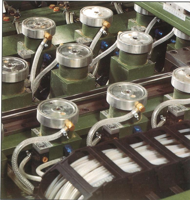
Die Teile werden über eine automatisch absenkende Rollenbahn in die Maschine transportiert, mit Anschlägen positioniert und pneumatisch gespannt. Die Aggregateanordnung von oben: Fräswerkzeuge für Ausschnitte, Eckverbindungen und Formfräsungen. Von unten werden die Ausfräsungen zum Einsetzen der Spanschrauben durchgeführt.
