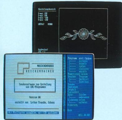
Die Software RANC 04 dient der Erstellung, Änderung, Manipulation und graphischen Darstellung von NC-Programmen. Erstellmöglichkeiten sind:
