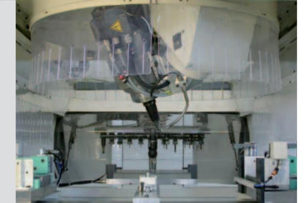
Spezialmaschine für die Bearbeitung von Caravan-Seitenteilen mit einem durch Druckrollen gesteuerten Sägeaggregat über der C-Achse. Materialtransport erfolgt über den angetriebenen Rollentisch.
