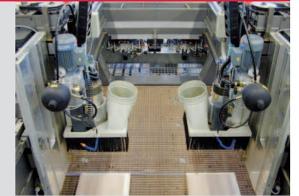
Beispiel zeigt ein Bearbeitungszentrum zur zerspanenden Bearbeitung mit Hartmetallwerkzeugen (Umriss- und Flächenbearbeitungen) von Sandwichplatten, bestehend aus Kernmaterial (Nomex Wabe) und Prepreg als Deckschicht. Ein spezielles Bohraggregat mit vertikal pneumatisch vorlegbaren und einzeln ansteuerbaren Bohrspindeln ist für Lochreihen- und Konstruktionsbohrungen im Flugzeugwabenmaterial ausgelegt.
