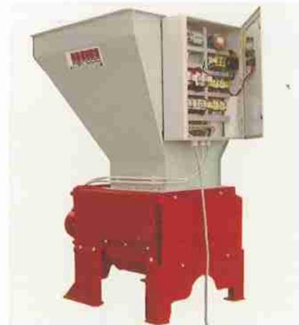
La robusta trituradora viene equipada con un mando electrónico, que protege la máquina de posibles sobrecargas, y se desconecta en caso de marcha sin carga.
