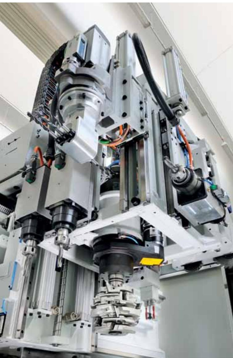
Gruppo di lavoro multifunzione con unità indipendenti e opzionali per eseguire lavorazioni di tenonatura, profilatura, foratura ecc.; movimentato da vite di grosso diametro per garantirne velocità e durata.
