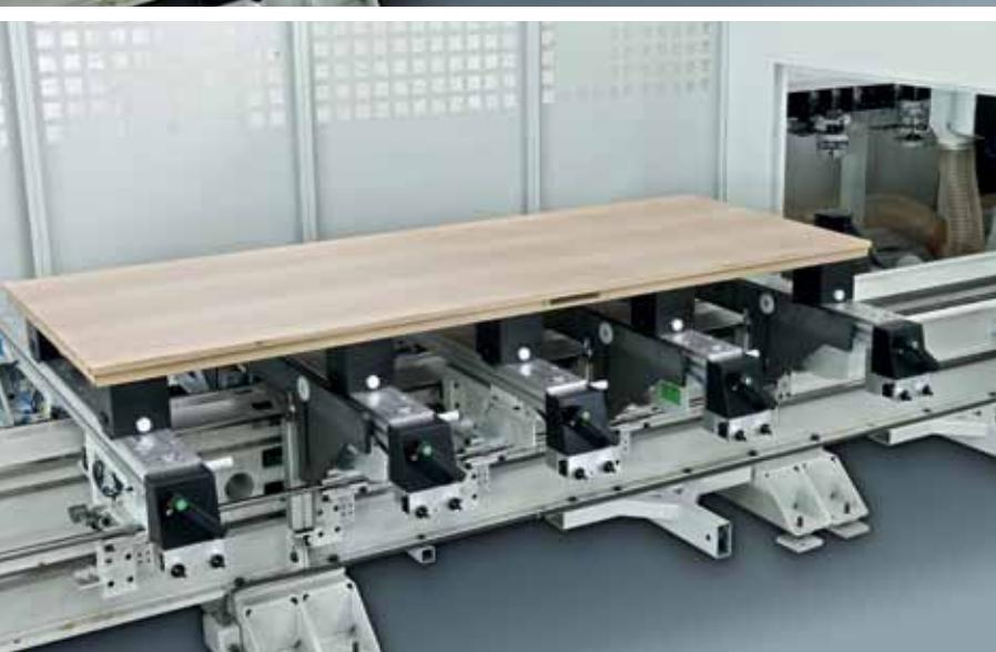
Sistema di bloccaggio adattabile a qualsiasi tipo di pezzo tramite morsetti pneumatici o con ventose di pressione.
