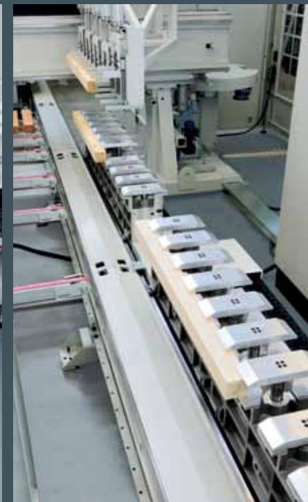
Motorisierte Beladung/Entladung Portal, Pufferkapazität von etwa 20 Werkstücken (die auf Anfrage gesteigert werden kann). Die Maschine kann unabhängig für zirka etwa 80 Minuten arbeiten und das ermöglicht dem Bediener die Montage der Fenster an der Presse durchzuführen.
