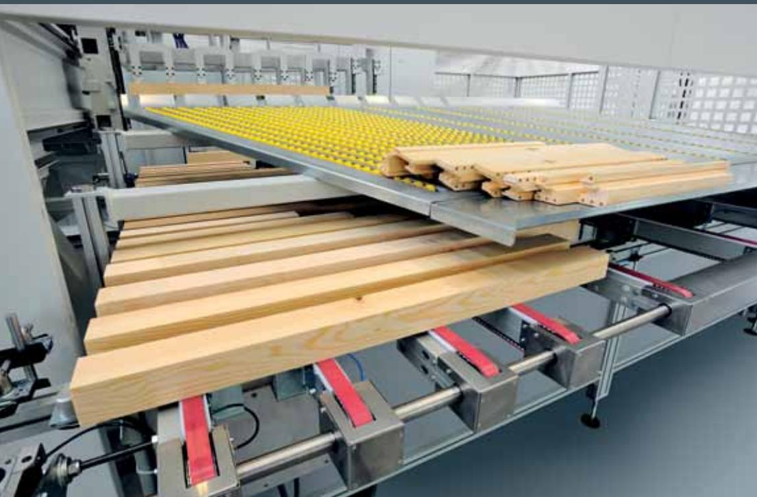
Polmonatura di carico/scarico motorizzata con una portata di 20 pezzi (è possibile aumentarne la capacità a richiesta).
