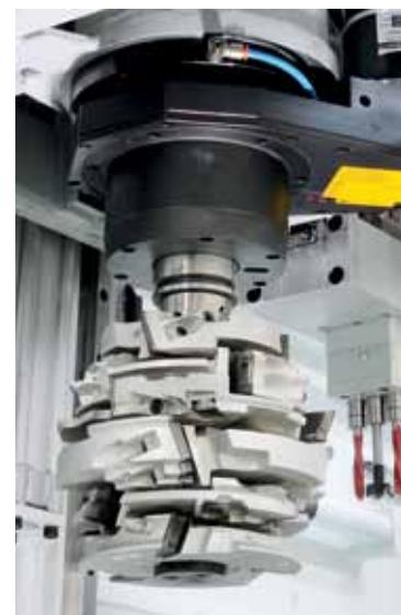
Multifunktions- Arbeitsgruppe mit optionalen unabhängigen Einheiten zum Zapfenschneid, Profilieren, Bohren etc., und einem Kugelumlauf-Gewinde-Getriebe mit großem Durchmesser, um die Geschwindigkeit und die Langlebigkeit zu gewährleisten.
