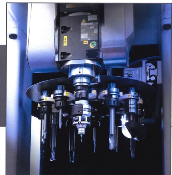
Die 5 Achsen Variante der Maschine ist mit präzisiertem automatischen Schwank und Dreh Kopf HS 662 ausgestattet. Automatischer Werkzeugwechsler wird vom Tellerförmigen Drehwechsler AVN12 oder vom Kettenwechsler mit Hilfs-hand AVN44 durchgeführt. Die Wechselzeit ist 7 Sekunden. Die Maschine wird standardmäßig mit HEIDENHAIN iTNC530 oder SIEMENS SINUMERIK 840D SL Steuerungssystemen ausgestattet.
