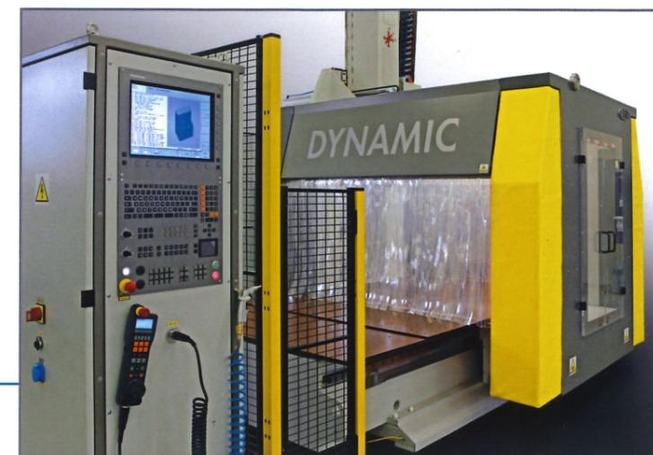
Bewegliche Teile der Maschine sind gegenseitig durch eine lineare Kugelleitung verbunden. Perfekte gegenseitige Abdichtung der linearen Bahnlinien und Wagonen, ihre große Überdimensionierung und automatische Zentralschmierung aller beweglichen Teile bürgt für hohe Steifigkeit und lange Haltbarkeit der Maschine. Lineare Bewegung der Achse X wird durch gehärteten, zemen-
