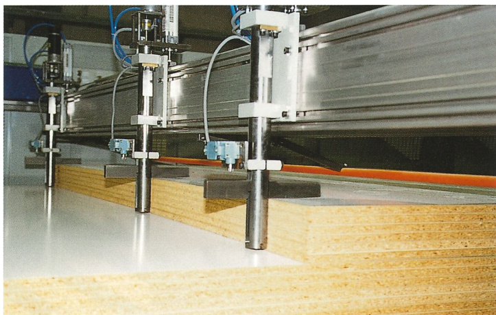
Separater Abschiebewagen mit Abschieber Separate push-off carriage Chariot chargeur séparé avec dispositif chargeur
