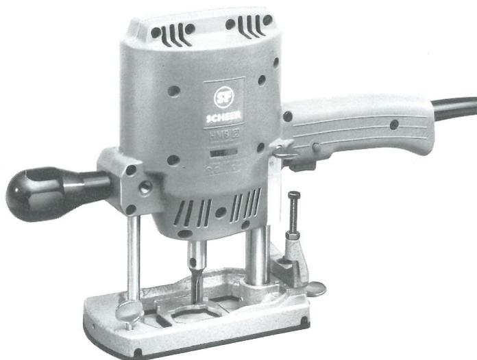
**Handoberfräse HM 9,** für leichte Fräsarbeiten mit Universalmotor für Gleich- und Wechselstrom, Leistung 1000 Watt bei nur 3,2 kg Nettogewicht, mit Mehrfachtiefenanschlag für 2 Frästiefen plus Durchgang, mit Außengewinde M 10 oder mit Spannzange (6 mm oder 1/4").
