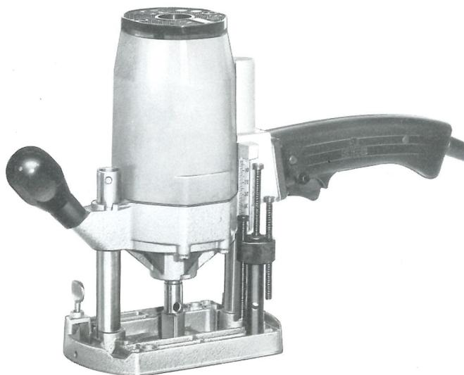
**Handoberfräse HM 14,** für mittelschwere Fräsarbeiten, ideal zum Beschlageinfräsen, mit Universalmotor für Gleich- und Wechselstrom, Leistung 1200 Watt bei nur 4,7 kg Nettogewicht, mit Revolveranschlag für 3 Frästiefen, mit Außengewinde M 10. Dieser Handfräsmotor ist gegen Aufpreis auch als Schnellfrequenzmotor lieferbar.
