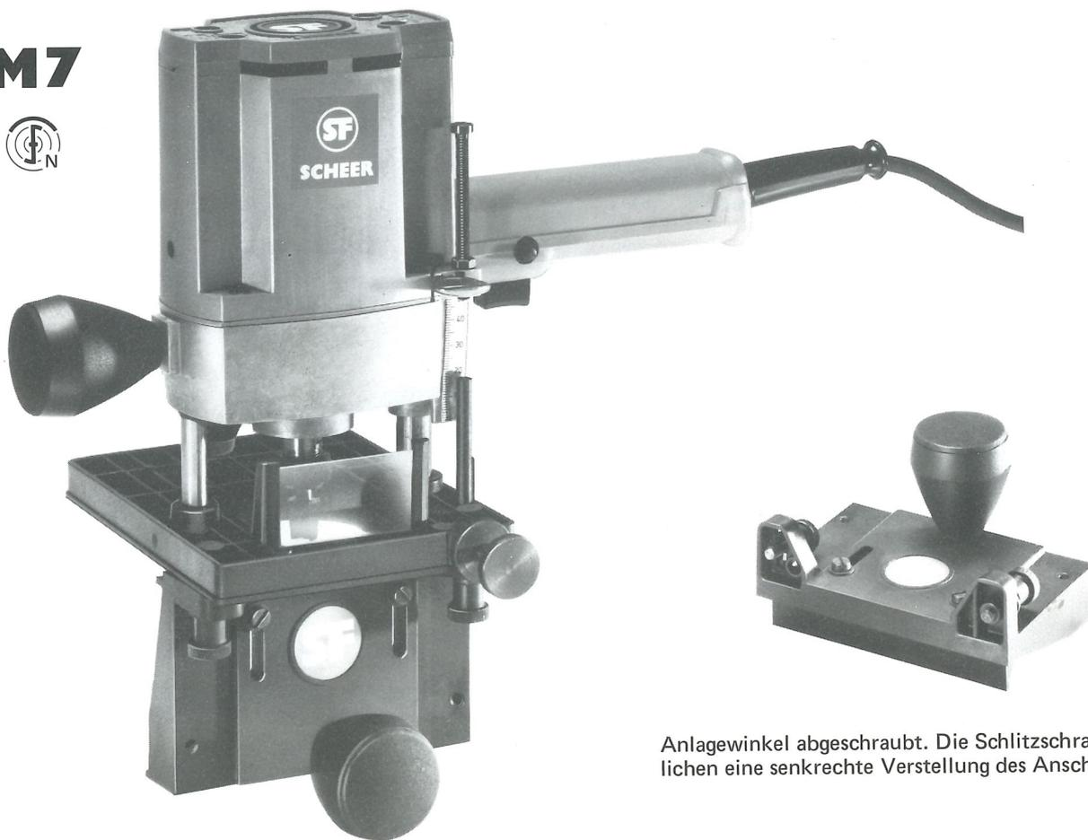
Anlagewinkel abgeschraubt. Die Schlitzschrauben ermöglichen eine senkrechte Verstellung des Anschlagsteiges.
