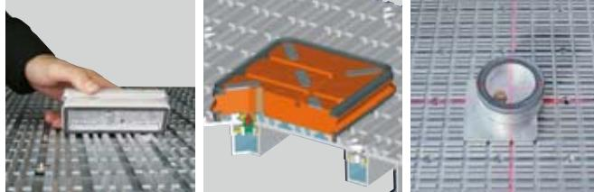
Das Einrüsten lässt sich praktisch und einfach durchführen; das exklusive Aluminiumprofil ist mit Nuten und Bohrungen versehen, die zur optimalen Positionierung jeder Art von Auflage ausgelegt sind. Noch schneller geht es mit einem Lasersystem, das die exakte Positionierung der Sauger ermöglicht.
