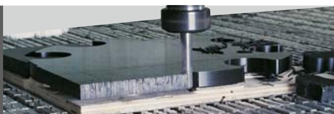
Die direkte Bearbeitung des Maschinentischs garantiert höchste Präzision und dauerhafte hohe Planparallelität dank der hohen Verwindungssteifigkeit. Ideal zur Bearbeitung von Kunststoff, Harz und Leichtlegierungen.
