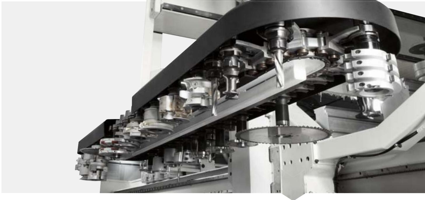
Der Kettenwechsler TRC mit 48 Plätzen für große Werkzeuge oder solche mit Doppelprofil sorgt dafür, dass die Maschine stets für jede Bearbeitung gerüstet ist.
