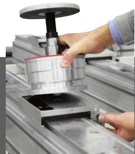
Praktischer und schneller Wechsel von Spannzylinder auf Sauger und umgekehrt. Der Bediener kann durch das von SCM entwickelte Schnellspannsystem per Knopfdruck und ohne Zuhilfenahme einer externen Vorrichtung arbeiten.
