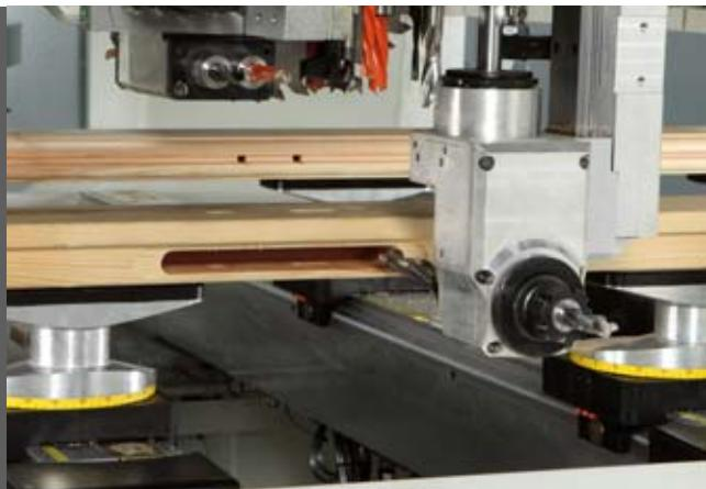
Die SCM Arbeitstische sind mit den gleichen Zubehörteilen ausgestattet und bieten stets eine sichere Werkstückspannung, um auch bei hohen Spanabnahmen eine hervorragende Oberflächenqualität zu erzielen.
