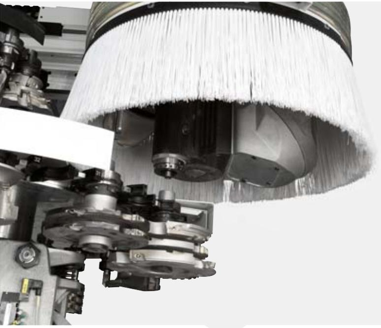
Das kompakte und leistungsstarke Prisma-Aggregat ermöglicht den Einsatz aller Arten von Werkzeugen, auch von dimensionierten, die für die aufwändigen Bearbeitungen von Fenstern und Türen erforderlich sind.
