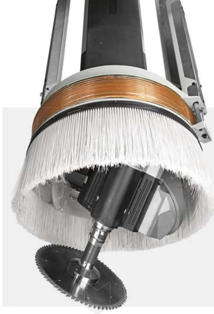
Ein vollständiges Programm an Arbeitsaggregaten mit 3 bis 5 interpolierenden Achsen ermöglicht es, allen Anforderungen gerecht zu werden, die an ein Bearbeitungszentrum gestellt werden.
