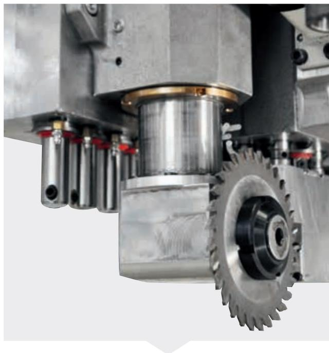
Cualquier tipo de perforación encuentra la solución óptima en la amplia gama de módulos a disposición de Accord fx que tiene desde 14 a 50 porta brocas independientes.
