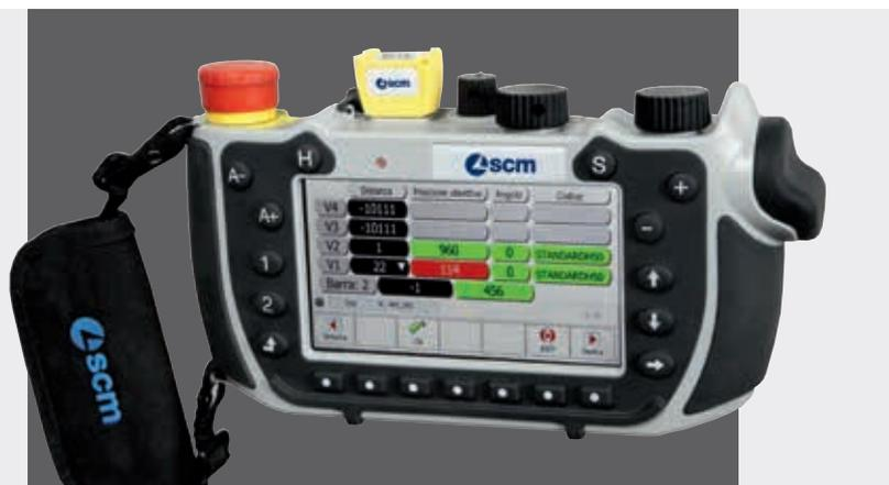
Operaciones rápidas que no requieren controles adicionales; en la pantalla de la consola móvil se visualiza la cuota de posicionamiento de cada elemento y se muestran en tiempo real todos los movimientos hasta que alcancen su posición correcta.
