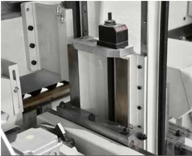
Die Arbeitsaggregate bewegen sich auf Schwalbenschwanzführungen angetrieben durch Trapezgewindespindeln mit mechanischer Positionsanzeige.
