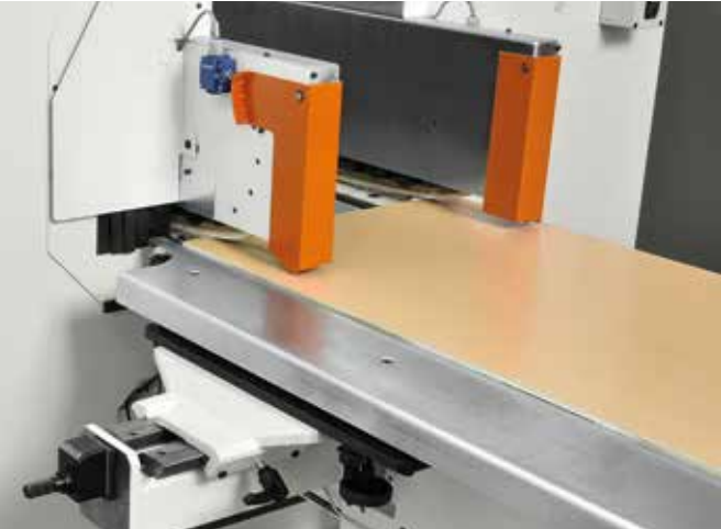
Referenzführung mit manueller Horizontaleinstellung des Materialabtrages.
