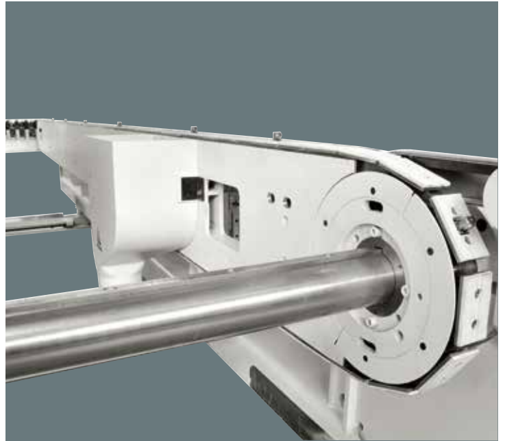
Vorschubkette mit Gleitlagern 65 mm für Werkstücke mit einer Breite von min 185 mm. (Nockenabstand 450 mm).
