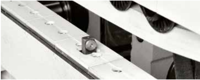
Vorschubkette mit Gleitlagern 65 mm für Werkstücke mit einer Breite von min 185 mm. (Nockenabstand 450 mm).
