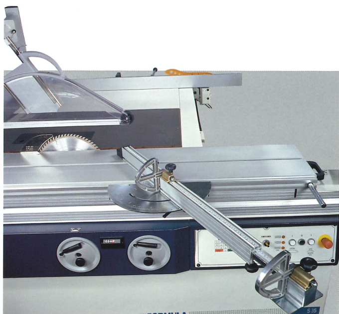
Dispositivo per tagli angolari composto da: - guida telescopica con due battute reversibili - lunetta con sistema di selezione rapida dell'angolo
