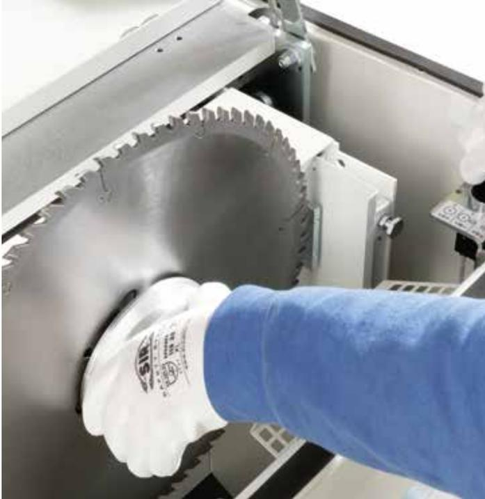
**SÄGEBLATTSCHELLSPANNSYSTEM: SICHERER ARBEITSABLAUF MIT KÜRZEN RÜSTZEITEN**
