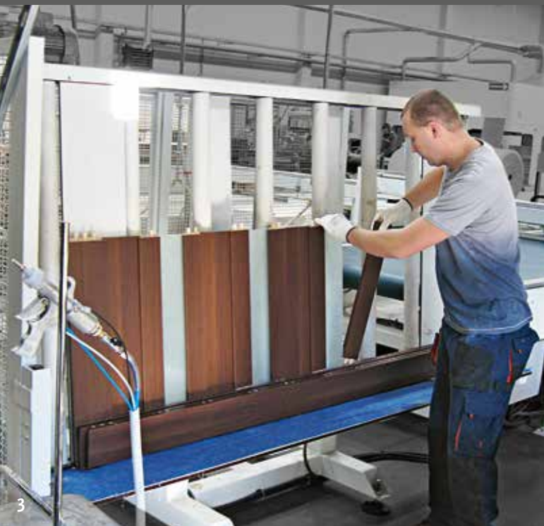
▲ 3, 4 Pre-ensamblaje en línea de puertas de interior con prensa Action h
