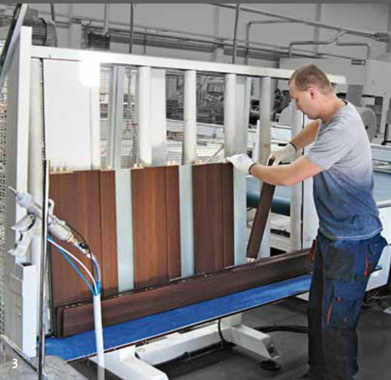
▲ 3, 4 Pre-assemblaggio in linea di porte da interno con strettoio Action h
