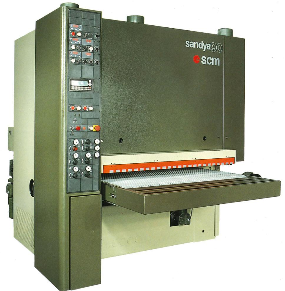
Das SCM Querband-Aggregat zeichnet sich durch große Kompaktheit und geringen Platzbedarf aus, was auf seine trapezförmige Struktur zurückzuführen ist, die darüber hinaus eine optimale Abmessung des Schleifbandes gewährleistet. Durch das Vorschleifen und den kreuzweisen Feinschliff wird ein Finish höchster Qualität gesichert.
