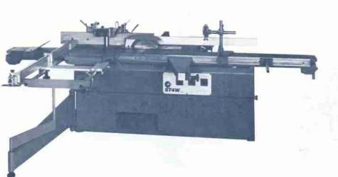
Kreissäge- Fräs- und Zapfenschneidmaschin for SCM ST 4 lie Kreissäge 5,5 PS, Fräse 5,5 PS Tischgröße 10eb 1360 mm, Schiebeweg des Rolltisches 1200 ich Sägeblattdurchmesser bis 400 mm, Schnitthön bis 132 mm, Werkzeugaufnahme 30 mm (2) 181
