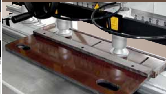
Vorrichtung für die Bearbeitung schmaler Werkstücke (Option)
