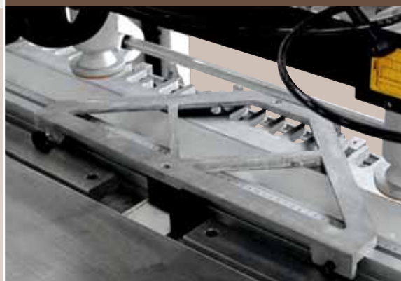
Vorrichtung für die Bearbeitung schmaler Werkstücke (Option)
