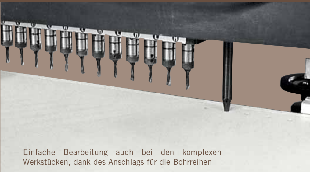
Revolveranschlag mit 6 Positionen und mechanische Anschläge auf Arbeitstisch, eine Garantie für Schnelligkeit und Präzision
