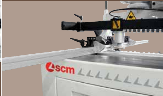
Zwei Anschläge L=1500 und 4 Seitenanschläge (Option)
