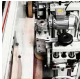
Leimauftrag Gerade Oberfläche
