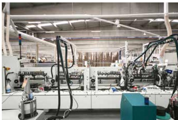
Groupe encolleur pour softforming avec zone de pression jusqu'à 4.5 m de long. Idéal pour tout type de profils avec des épaisseurs de chant supérieures à 0.6/0.8 mm et colle EVA/PU.
