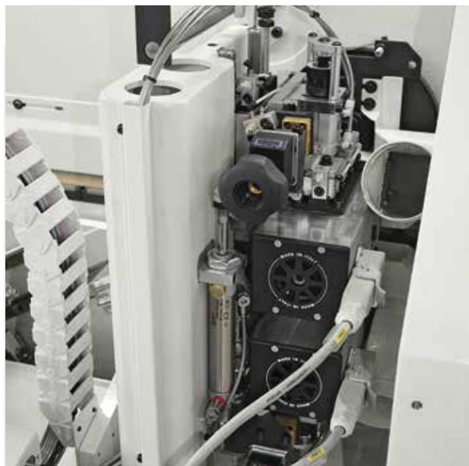
Groupe d'affleurage pour l'usinage de l'excédent supérieur/ inférieur de chant.
