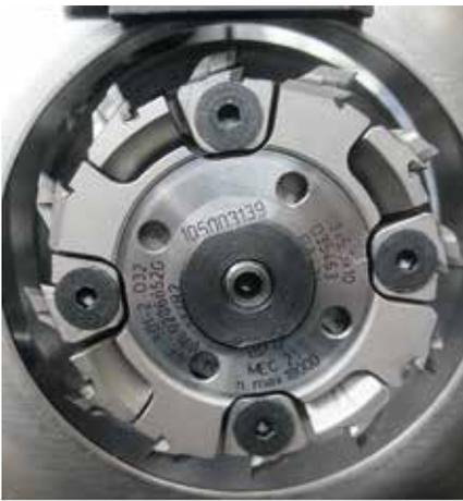
Usinage jusqu'à 3 rayons + toutes épaisseurs de chants minces avec changement immédiat par CN grâce aux dispositifs MULTIEDGE compacts et légers. Outils monobloc à 4 coupes avec vitesse de rotation jusqu'à 18.000 tpm
