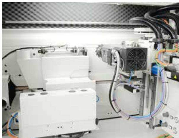
Groupe de fraisage pour rainures avec changement flexible jusqu'à 8 outils par CN.
