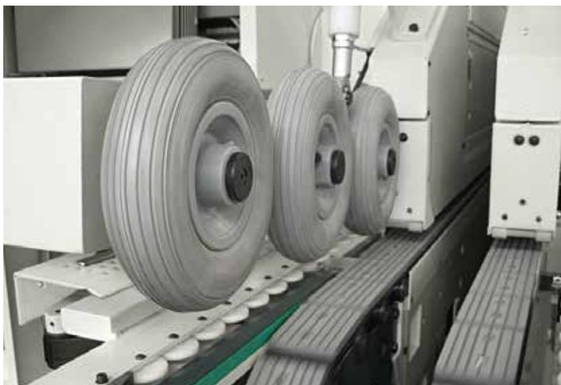
Système d'alignement au guide en entrée pour les machines en version pour l'usinage du passage longitudinal uniquement
