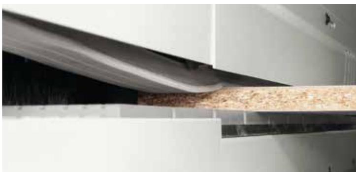
Mouvement fluide et précis du panneau grâce au presseur à courroie soutenu par un presseur solide en acier indéformable.
