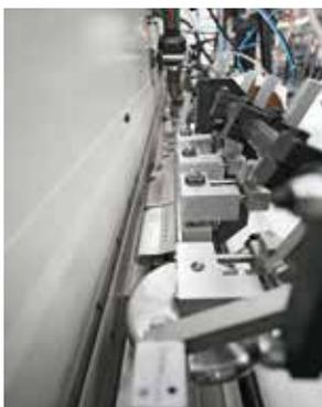
La zone de pression du chant est équipée en fonction du profil à réaliser avec des patins refroidis ou une combinaison de patins/rouleaux.
