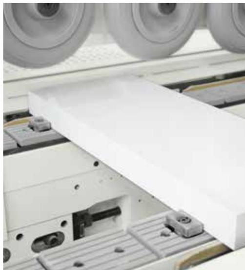
Système à double taquet pour le transport précis et constant du panneau le long de la machine pendant l'usinage transversal. Afin d'assurer la productivité maximale possible avec des panneaux de toutes dimensions, la distance entre les taquets peut être choisie parmi les suivantes: 900 mm, 500 mm, 400 mm, 300 mm. Les taquets sont automatiquement réglés en hauteur.
