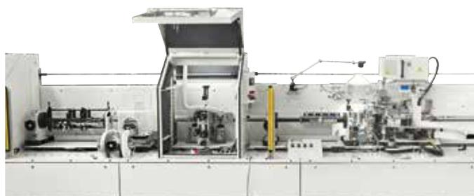
Groupe encolleur pour l'usinage de portes avec chants en placage doux et rigide.
