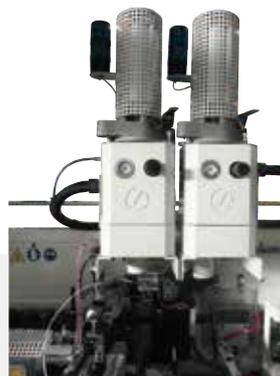
Dispositif de préfusion compact pour colle PU en cartouches de 2 kg intégré dans la machine avec une capacité de fusion jusqu'à 6 kg/h
