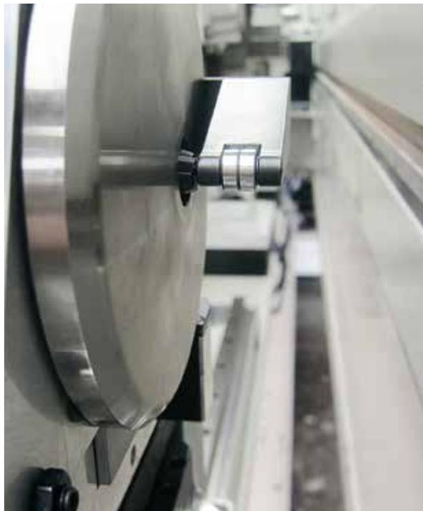
Copieurs spécifiques pour l'usinage des panneaux profilés J-SHAPE.
