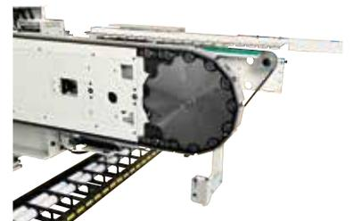
Le transport des panneaux précis et constant au cours des années est assuré par des chaînes constituées de maillons en matériau fritté et isotrope transportés par des roulements à rouleaux de haute précision qui se déplacent sur des guides indéformables avec un couple inamovible.
