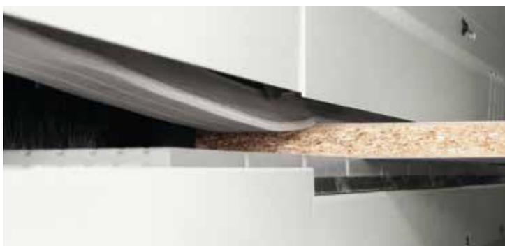
Movimento del pannello fluido e preciso grazie al pressore a cinghia sostenuta da un solido pressore in acciaio indeformabile.
