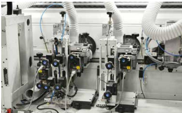
Gruppo profilatore per la preparazione della giunzione
