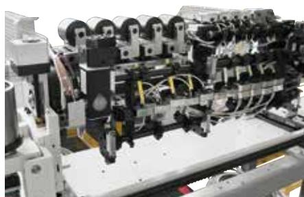
Fino a 4 profili installabili nella stessa macchina con rotazione manuale o da CN.
