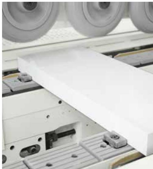
Sistema a doppio piolo per il preciso e costante trasporto del pannello lungo l'attraversamento di tutta la macchina nella lavorazione trasversale. Per garantire con ogni dimensione di pannello la produttività massima possibile, il passo pioli è disponibile tra: 900 mm, 500 mm, 400 mm, 300 mm. I pioli si regolano automaticamente in altezza.
