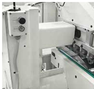
La cinghia superiore è motorizzata (**stefani sb**) per garantire anche nel caso di pannelli grandi e pesanti le migliori condizioni di trasporto del pannello. Il movimento verticale del pressore è gestito in automatico da CN in funzione dello spessore del pannello.
