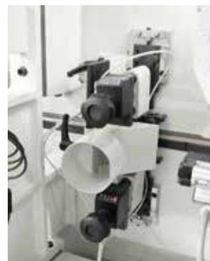
Gruppo raschiafilo per la rimozione del bordo in esubero e per la finitura del profilo.
