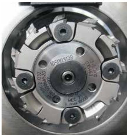
Lavorazione fino a 3 raggi + infiniti sottili con scambio istantaneo da CN con i dispositivi MULTIEDGE compatti e leggeri. Utensili monoblocco a 4 taglienti con velocità di rotazione fino a 18.000 rpm.
