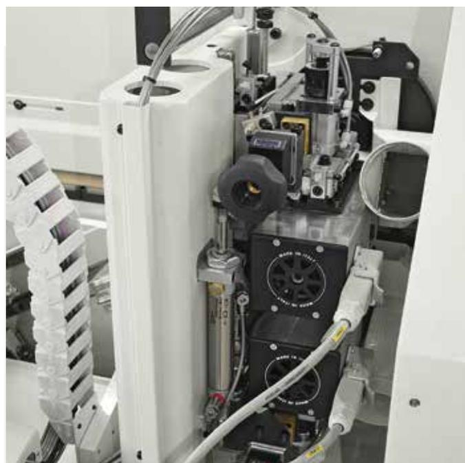
Gruppo refilatore per la lavorazione dell'eccedenza superiore/inferiore del bordo.
