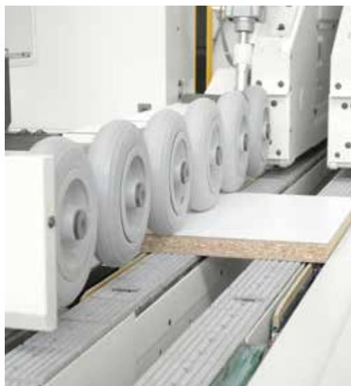
Sistema di accostamento alla guida in entrata per macchine nella versione per lavorazione del passaggio longitudinale + trasversale.
