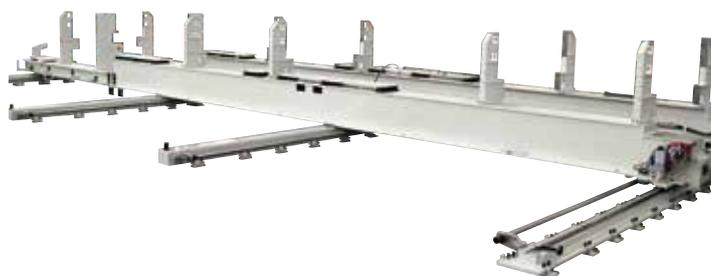
I basamenti vengono assemblati in una struttura scatolata chiusa con elementi in acciaio ad altissima rigidezza torsionale.
