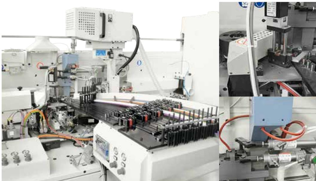
Possibilità di sistema di alimentazione e di taglio del bordo motorizzato con precisione di +/- 2 mm al fine di ottimizzare i costi dello sfrido.
