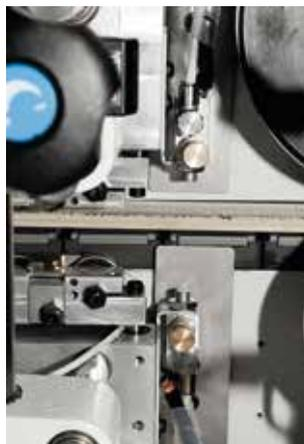
Dispositivo a spruzzo per la lubrificazione delle lame e per la ravnatura dei bordi in ABS.
