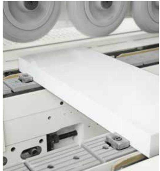
Doppeltes Zapfensystem für den präzisen und konstanten Transport der Platten über die gesamte Maschine in Querbearbeitung. Um für jede Plattengröße die höchstmögliche Produktivität zu garantieren, ist der Zapfenabstand erhältlich zwischen: 900 mm, 500 mm, 400 mm, 300 mm. Die Zapfen werden automatisch in der Höhe reguliert.
