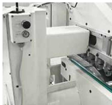
Das obere Förderband ist motorisiert (**stefani sb**), um auch im Fall großer und schwerer Platten die besten Beförderungsbedingungen Platte zu gewährleisten. Die Vertikalbewegung der Pressvorrichtung wird automatisch vom CNC je nach Plattenstärke vorgenommen.
