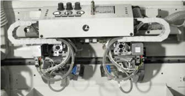
Das Sortiment der horizontalen Kappaggregate für den Schnitt von überstehenden Kanten nach der Verleimung, die die Produktivität mit bis zu 30m/min optimieren. Präziser und konstanter Schnitt durch frontale und seitliche Abtaster. Regulierbarer Überstandschnitt, auch über CNC.
