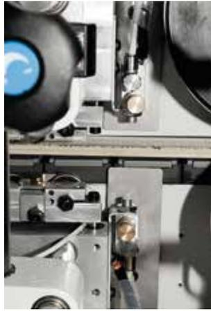
Spritzvorrichtung für die Schmierung der Schneiden und das Polieren der Kanten aus ABS.
