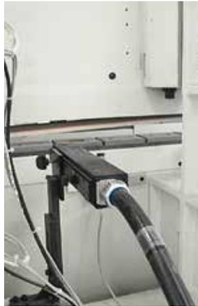
Tintenstrahldrucker für die Kennzeichnung der Platten auf der oberen oder seitlichen Oberfläche.
