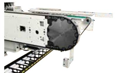
Der über die Jahre stets präzise und dauerhaft zuverlässige Bandlauf der Platten erfolgt auf gesinterten isotropen Kettenmaschen und auf hochpräzisen Wälzlagerrollen, die sich auf unverformbaren Führungen mit fester Kupplung befinden. Die hohe, vom Markt bestätigte Zuverlässigkeit dieser Lösung gewährleistet sehr lange Wartungsintervalle zu geringen Kosten.
