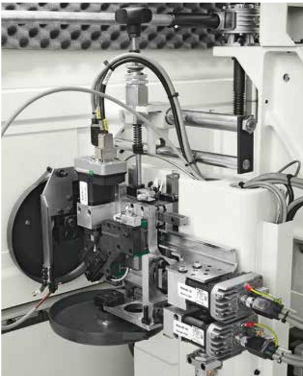
Aggregat für die abschließende Glättung der zuvor mit dem Werkzeug bearbeiteten Kanten.
