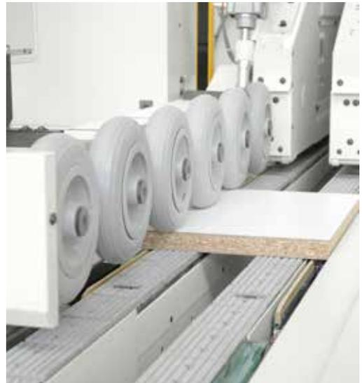
Ausrichtsystem zur Einlaufführung für Maschinen, die im Längs- und Querdurchlauf bearbeiten.
