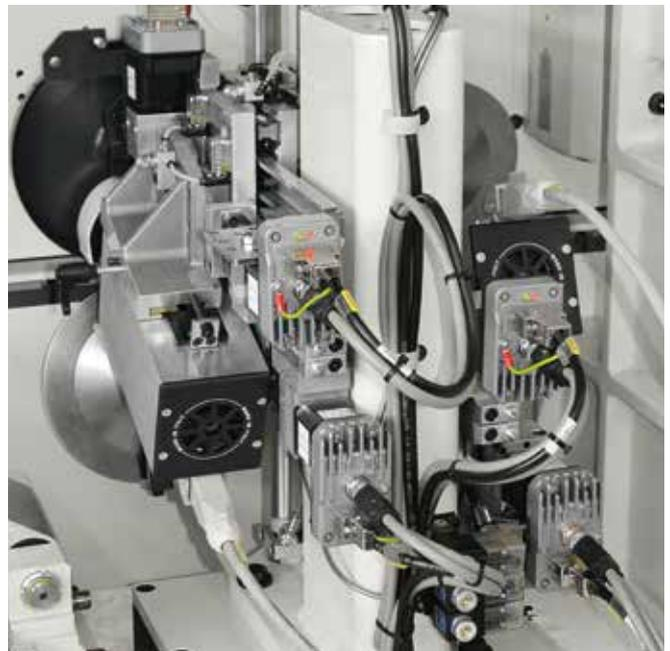
Fase- und Radiusfräsaggregat für die Fertigbearbeitung der Kante mit Abschrägung/Radius. Leistung: bis zu 1.8 kW
