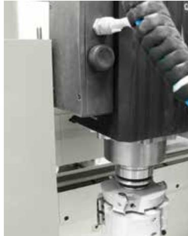
Möglichkeit des Anschlusses von Motoren mit HSK-Auskopplung und der Installation weiterer Werkzeuge an der Welle.
