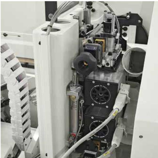
Bündigfräseraggregat für die Bearbeitung des oberen/unteren Kantenüberstands.
