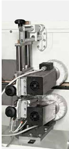
Vorrichtung mit drehenden Bürsten für die Kantenpolitur und die Endreinigung der angebrachten Kanten.
