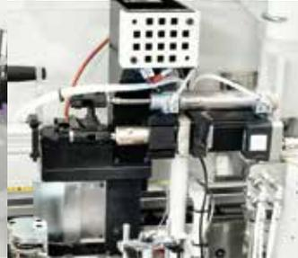
CNC-gesteuerte Leimdosierung je nach Leimtyp oder verwendetem Plattentyp. Automatische Leimaustrittsarretierung bei stillstehender Maschine.
