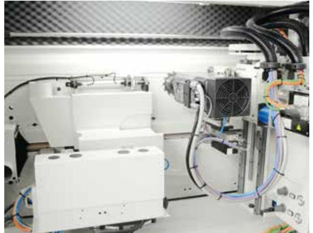
Flexibles Fräsaggregat für die Anfertigung von Nuten/Schlitten mit flexiblem Wechsel bis zu 8 Werkzeugen über CNC.
