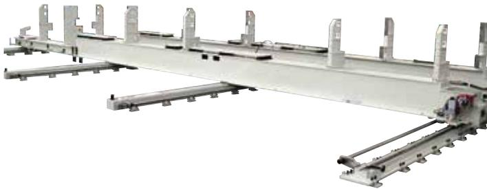
Die Untergestelle werden in einem geschlossenen Kastengestell mit Stahlelementen mit sehr hoher Verdrehsteifigkeit verbaut.
