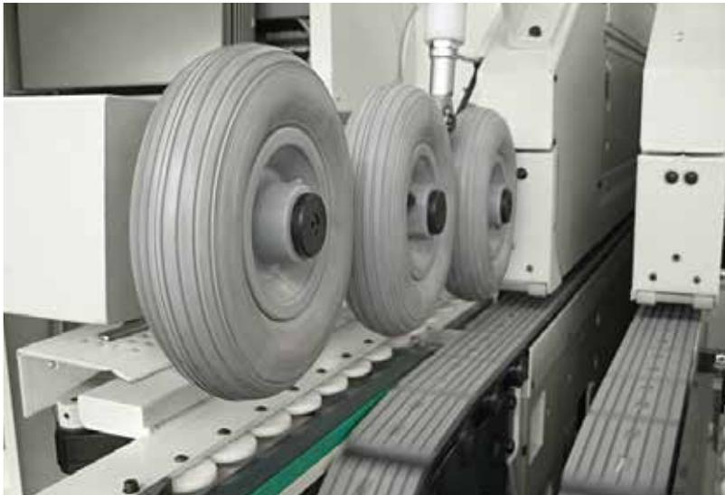
Ausrichtsystem zur Einlaufführung für Maschinen, die ausschließlich im Längsdurchlauf bearbeiten.
