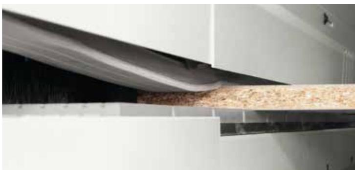
Dank des Riemenandrückers, der von einem soliden Andrücker aus unverformbarem Stahl gehalten wird, ist die Fortbewegung der Platte flüssig und präzise.
