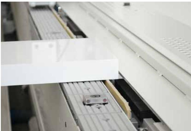
Hebesystem und Zapfen-Wartevorrichtung mit mehreren Abschnitten, die die Maximierung der Produktivität bei allen Plattengrößen gewährleisten.
