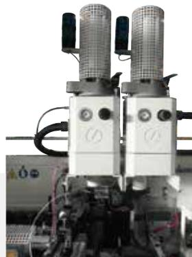
Kompakte, in die Maschine eingebaute Vorschmelzvorrichtung für PU-Leim in 2kg-Kartuschen mit einer Schmelzkapazität bis zu 6 kg/h. Flexibler Wechsel des PU-Leims mit 2 Vorrichtungen.
