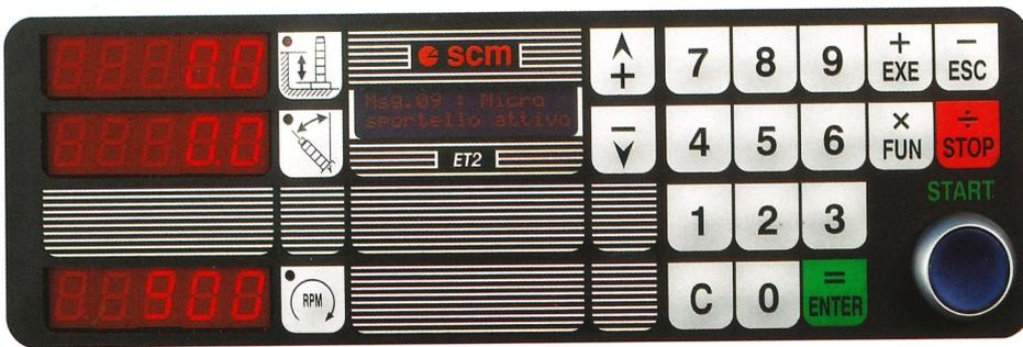
Positionneur pour arbre porte-outils et afficheur visualisant la vitesse de rotation de l'outil
