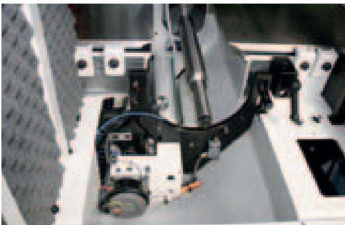
In der Regel sind die Verfahren zum Abziehen sehr zeitaufwendig und erfordern qualifizierte Arbeitskräfte. Um diese Eingriffe einfach, schnell und präzise durchzuführen, verschiebt sich der Stein auf Topset Master automatisch, sowohl axial als auch radial, mittels eines elektronischen Systems mit vor-eingestellten Geschwindigkeiten, je nach Stein- bzw. Werkzeug-Typ und nach Abtragung.
