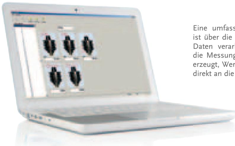
Eine umfassende Verwaltung des Produktionsprozesses ist über die Software „GT Soft“ möglich: hier können die Daten verarbeitet werden, die das Projektionsgerät für die Messung der Werkzeuge überträgt, neue Programme erzeugt, Werkzeug-Tabellen aktualisiert und Informationen direkt an die NC der Maschine geschickt werden.
