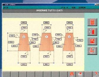
I tagli con lama inclinata e/o guida angolata sul piano sono assistiti dall'elettronica che calcola la corretta posizione della battuta
