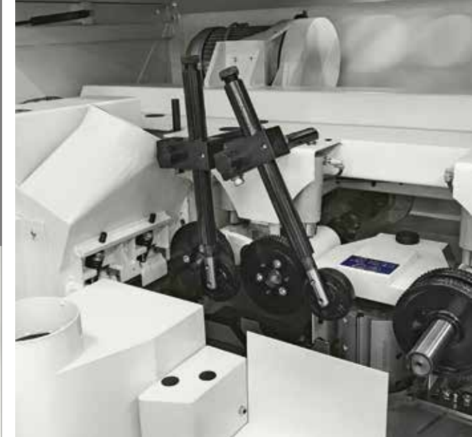
Vertikalandruckrollen vor Vertikalspindeln Leistungsfähig unter allen Bedingungen.
