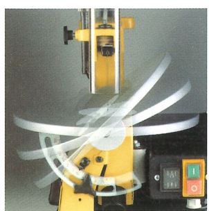
Der Arbeitstisch kann für Gehrungsschnitte von 0° bis 45° verstellt werden.
