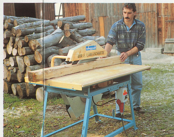
Links: scheppach KEZ 700 beim Querschnitt. Die Säge bleibt an der Dreipunktaufhängung. Oben: scheppach KE 70m mit Drehstrommotor und Keilriemenantrieb. Unten: Längsschnitt mit der KE 60M mit Flanschmotor.
