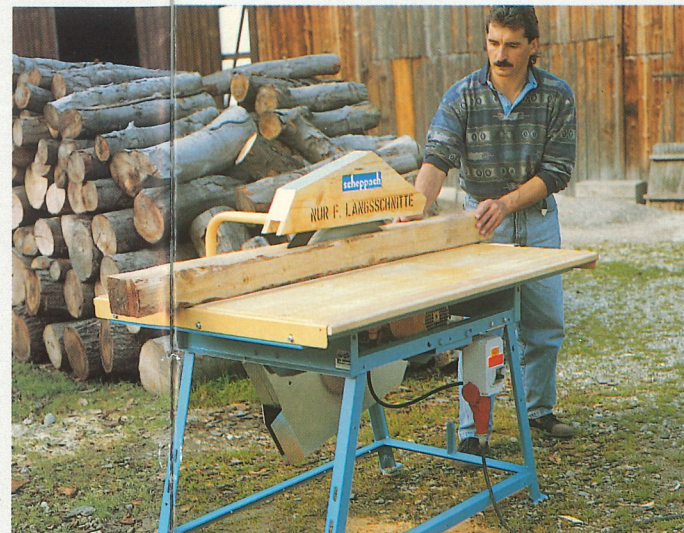
Links: scheppach KEZ 700 beim Querschnitt. Die Säge bleibt an der Dreipunktaufhängung. Oben: scheppach KE 70m mit Drehstrommotor und Keilriemenantrieb. Unten: Längsschnitt mit der KE 60M mit Flanshmotor.
