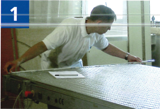
Step 1: Abmessen des Bearbeitungstisches bzw. der vom Kunden gewünschten Arbeitsfläche
