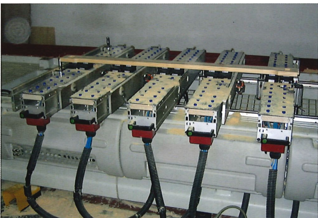
Umrüstung Konsolentisch durch Steel-Plate mit Mono-Base und diversen Sauger-Cups
