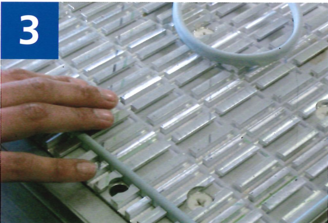
Step 3: Einlegen der Dichtschnur in das Raster des Bearbeitungstisches
