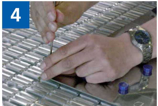
Step 4: Anbringen der Innospann Steel-Plate(s) auf den Bearbeitungstisch
