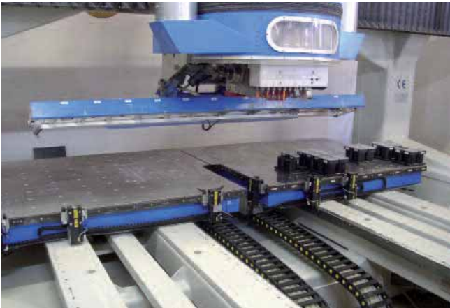
Umrüstung Glatttisch durch Steel-Plate-T mit Quad-Base-T und diversen Sauger-Cups
