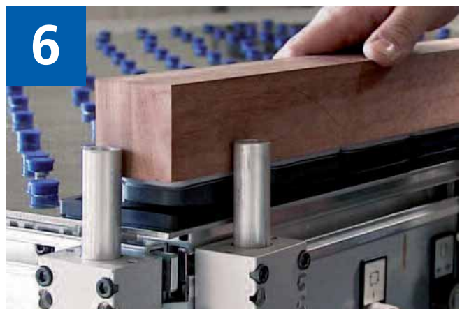
Step 6: Jetzt ist die CNC-Maschine fertig nachgerüstet und bereit zur Werkstückpositionierung und anschließenden -bearbeitung
