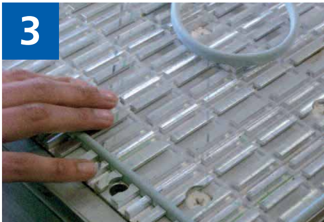
Step 3: Einlegen der Dichtsnur in das Raster des Bearbeitungstisches
