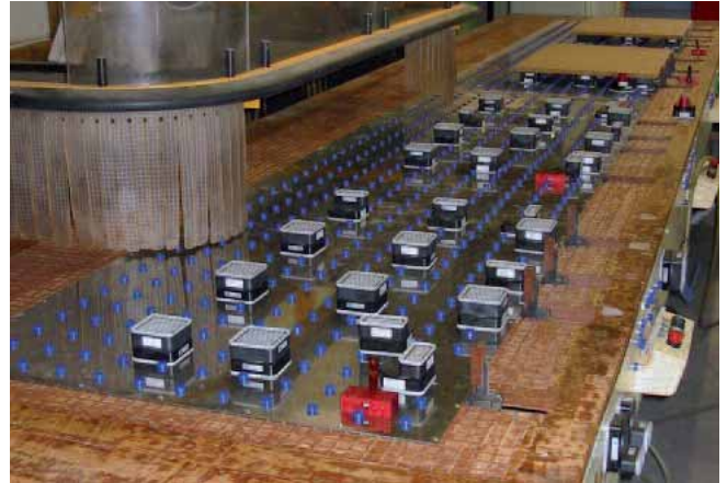
Umrüstung Rastertisch durch Steel-Plate mit Mono-Base und diversen Sauger-Cups (Standardnachrüstung)
