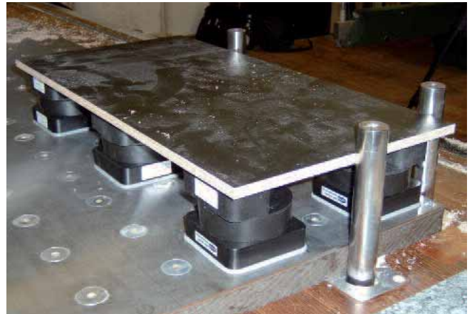
Umrüstung Glatttisch durch Steel-Plate-T mit Mono-Base-T und diversen Sauger-Cups. Montage direkt auf Raster-Zwischenplatte
