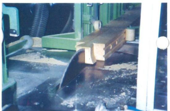
*Des assemblages spéciaux, par ex. pour les planches de bois bombées, les assemblages standards serrures tyroliennes ou éclavement d'une cheville sur virole appartiennent au répertoire du programme du châlet-machine, qui de manière générale est fourni avec un fonctionnement semi- ou complètement automatique.*
