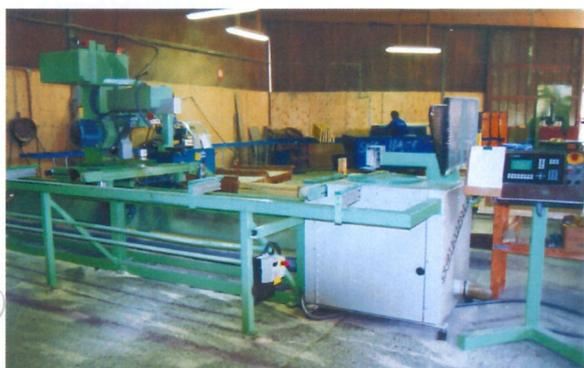
*L'appareil permet une fabrication rationnelle de charpente 4 pentes et coupes d'empanons en continu.*
