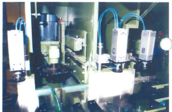
*Les unités de fraisage nécessaires aux assemblages-châlet sont fournies pour les pièces de travail jusqu'à une grandeur max. de 250x320 mm. Bien-sûr tous les agrégats sont adaptables à la grandeur max. de la pièce de travail.*
