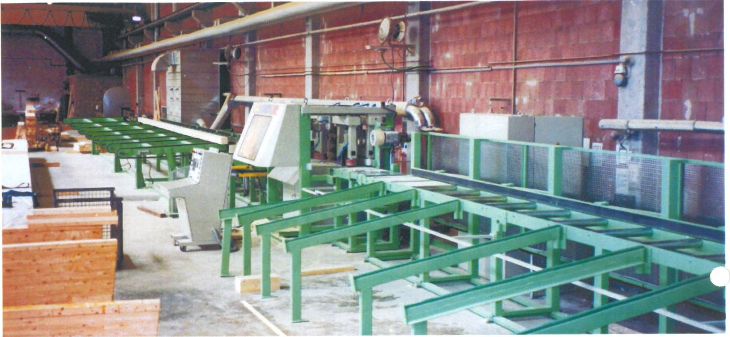
*La SCHMIDLER S2 est une scie de coupe hautement rationnelle pour les coupes continues en longueur. Elle est équipée d'un système de mesure et de transport breveté, qui établit de nouvelles normes par ses performances de rendement et largeur d'usage.*
