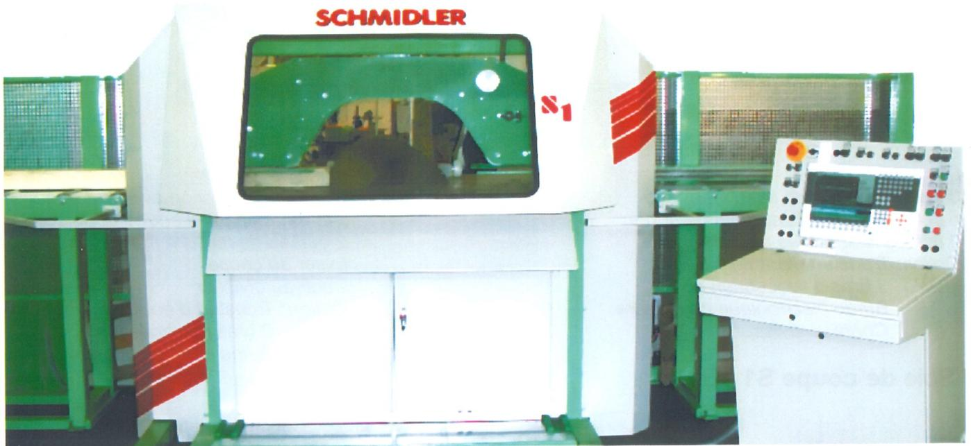
Scie de coupe moderne automatique munie d'un **système original de transport et de mesure** du bois qui autorise des coupes en continue à haut rendement (système breveté).
