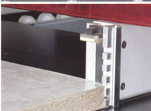
Sistema a pettine per la sezionatura anche in pacchi di materiali con bordi sporgenti. La rapida sostituzione dei pettini è garantita da un sistema brevettato Selco.
