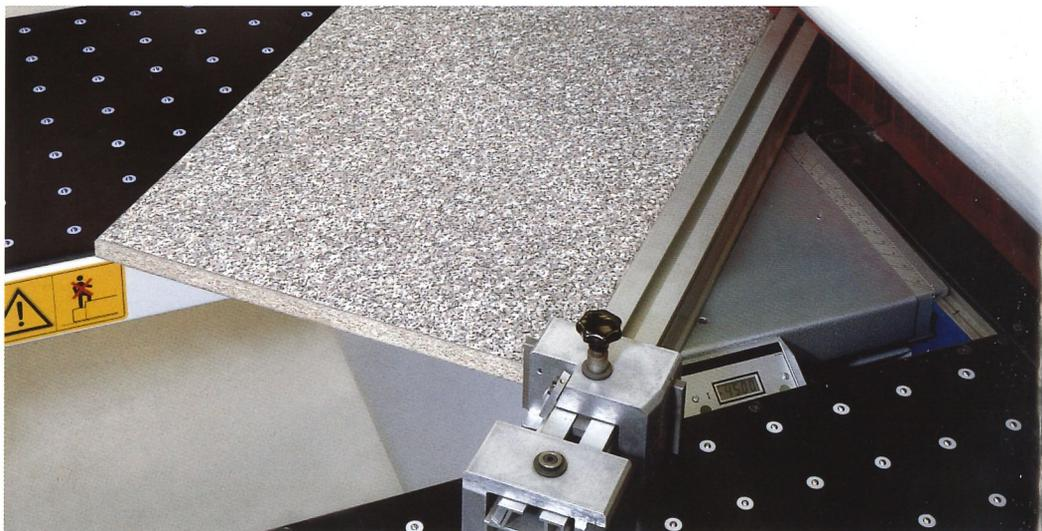
Dispositivo per tagli inclinati con posizioni fisse a 15° / 22,5° / 30° / 45°, oppure con regolazione infinita e lettura su display digitale.
