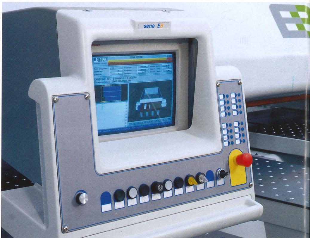
Controllo numerico con PC e video da 15" a bordo macchina e sistema operativo multitasking, "Windows '95" o "Windows '98".
