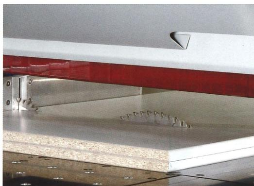
Funzione PFS per l'esecuzione di tagli di pannelli soft e post-formatati. Uno speciale programma del controllo numerico permette la perfetta incisione sia del punto di ingresso che del punto di uscita, evitando la scheggiatura di materiali fragili e delicati (Brevetto Selco).
