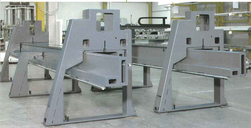
Il basamento principale della macchina è costituito da una solida struttura monolitica di acciaio normalizzato e da robusti supporti che ne garantiscono la perfetta stabilità. Le guide di scorrimento del carro portalamina sono posizionate sulla medesima trave assicurando quindi il perfetto parallelismo e rettilineità delle medesime. Le guide sono cementate e rettificate per garantirne nel tempo precisione e durata.
