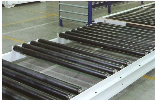
Optional: il Telaio di sollevamento della tavola elevatrice può essere corredato di rulli folli o motorizzati per permettere l'introduzione laterale o posteriore della pila tramite una prerulliera esterna.
