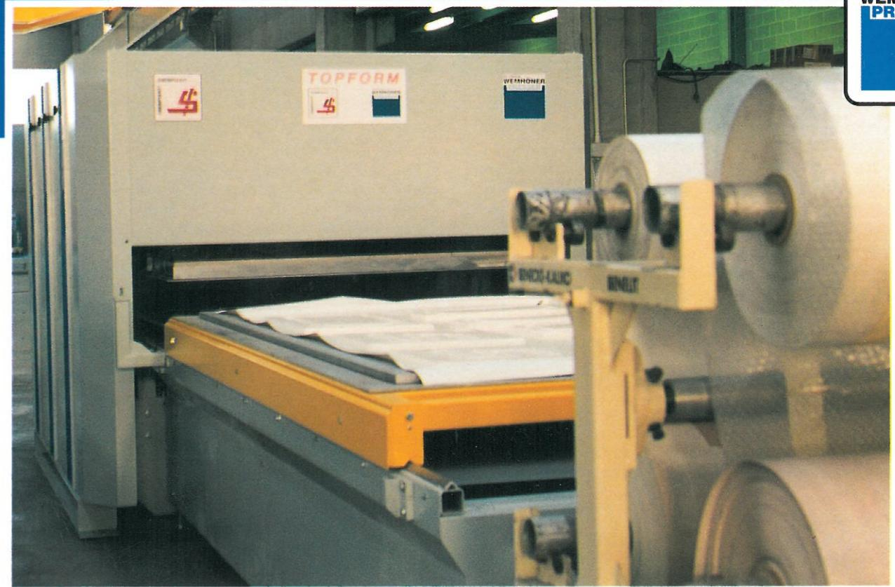
**Membranpressen ohne Membrane in Betrieb. Das Modell TOPFORM wird entweder mit
