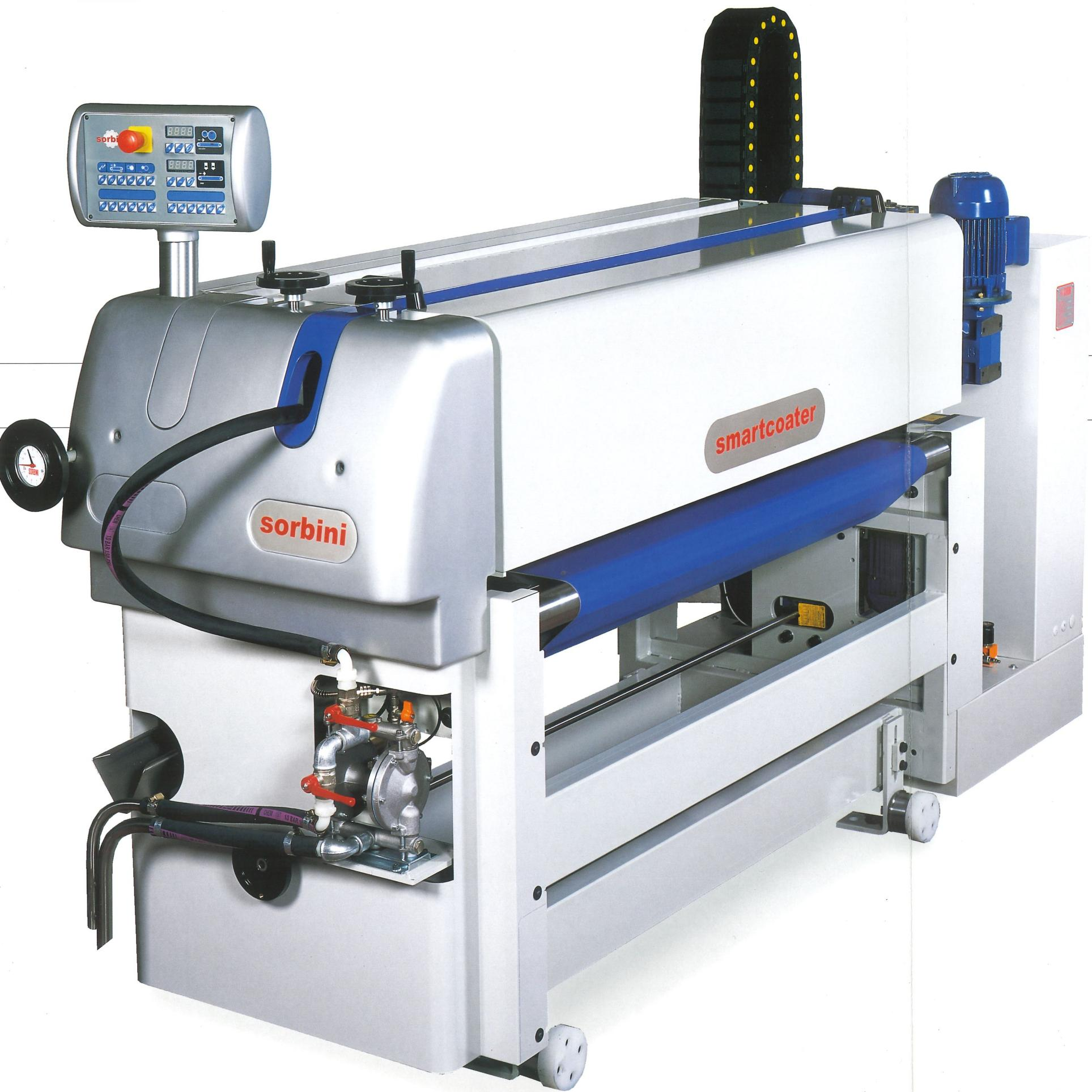
*smartcoater* è dotata di ruote su binari per facilitare le operazioni di pulizia e manutenzione.
