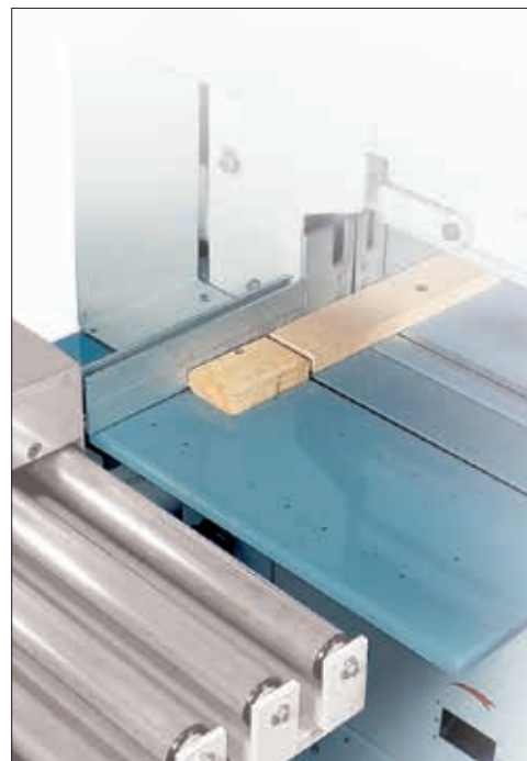
Auswurf der Kapp- und Reststücke der geraden Schnitte (geschlossen)
