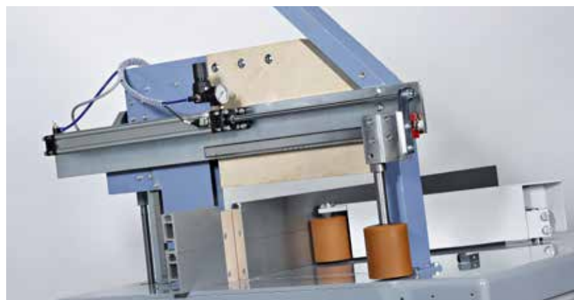
Detail der Frontdruckführungen.
