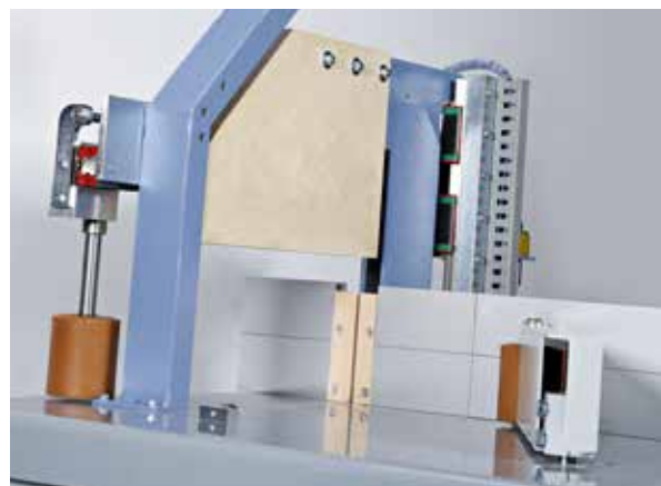
Detail des oberen Niederhalters.
