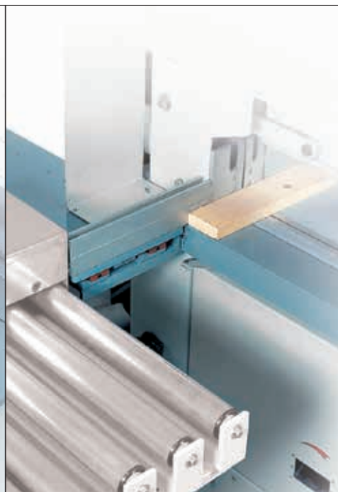
Auswurf der Kapp- und Reststücke der geraden Schnitte (offen)
